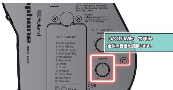
※ 工場出荷時は [VOLUME] つまみでスピーカーとヘッドホンの音量が同時に変化します。
