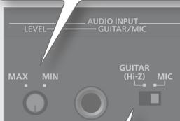
ギターを接続したときは「GUITAR」に、マイクを接続したときは「MIC」に設定します。
