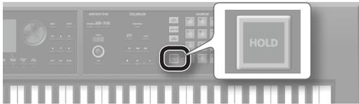
パッドから手を離してもサンプルの再生が続きます。サンプルを停止するときは、もう一度パッドを押します。
