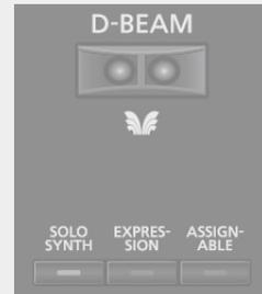
2. 鍵盤を弾きながら、D-BEAM コントローラーに手をかざします。
