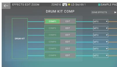
In diesem Bildschirm können Sie die Hauptparameter für die sechs Kompressoren des Drumkit verändern, z.B. ein- und Ausschalten der einzelnen Kompressoren und Festlegen des Ausgangsziels.
