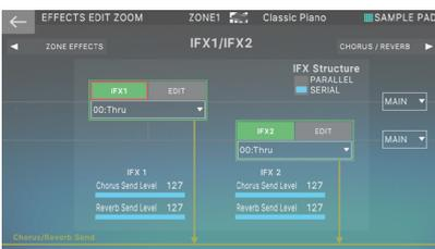
In diesem Bildschirm können Sie wichtige Parameter wie den IFX ON/OFF-Status, die IFX-Verbindungsreihenfolge, den Effekttyp, den Sendepiegel und das Ausgabeziel des IFX bearbeiten.
