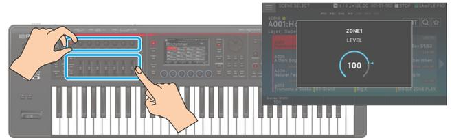
Wenn Sie mit einem Regler oder Fader eine Einstellung verändern, erscheinen die geänderten Parameter und deren Werte in einem zusätzlichen Display-Fenster.
