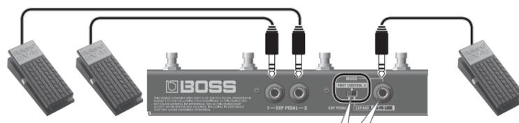
Per utilizzare un terzo pedale di espressione, impostate l'interruttore [MODE] su "EXP PEDAL 3" (solo sugli ampli che supportano il GA-FC EX).
