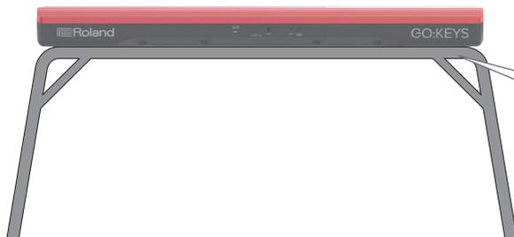
Ajuste a largura do suporte para que os pés de borracha na frente do GO:KEYS encaixem nos orifícios correspondentes.
