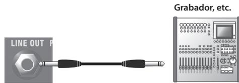
Puede usarlo junto con un sistema de PA externo o para grabar su interpretación a través de la línea directa mientras controla el sonido del altavoz del KATANA Mk II.
