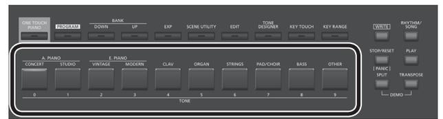
設定項目によっては、TONE ボタン ([0] ~ [9]) をテン・キーとして使い、数値を直接指定できるものがあります。TONE / PROGRAM / SCENE / ZONE EDIT 画面でテン・キーとして使うときは、[SHIFT] ボタンを押しながら操作します。テン・キーで数値を入力すると画面の値が点滅します。点滅している状態では値が確定されていないので、[ENTER] ボタンを押して確定させます。
