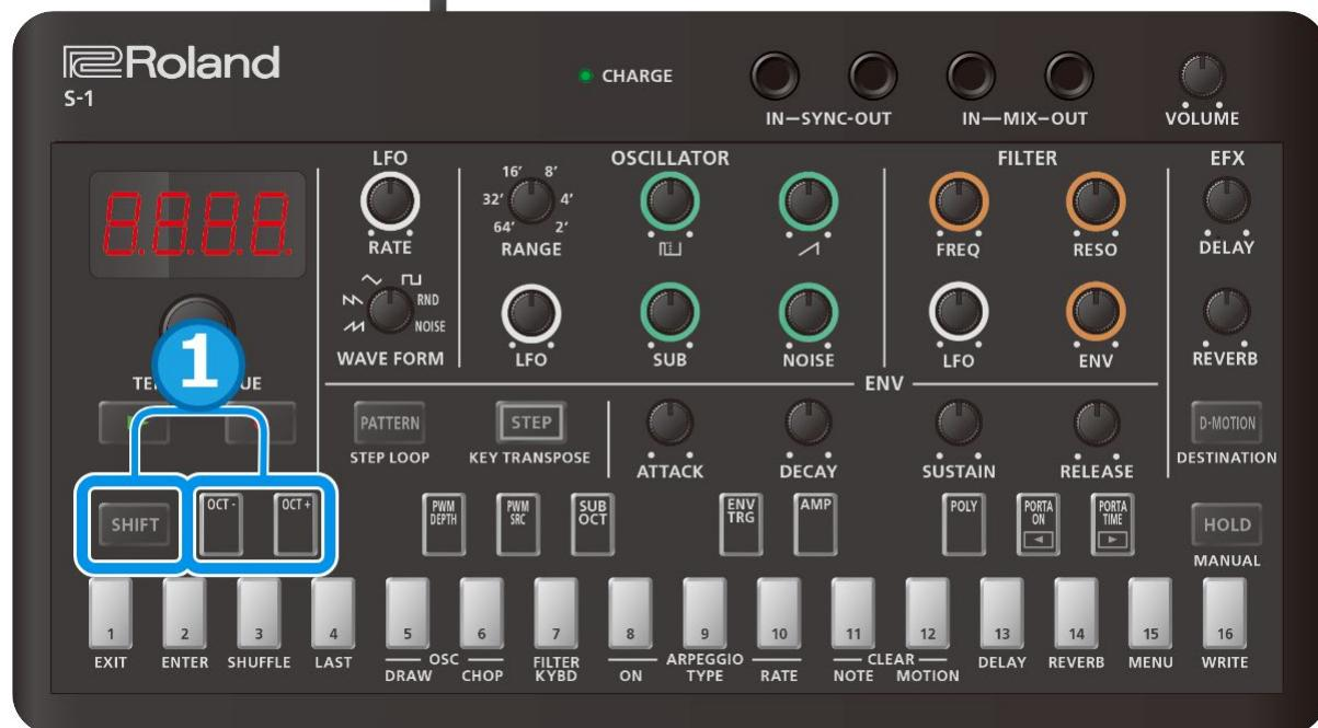
1. Halten Sie den [SHIFT]-Taster gedrückt und drücken Sie die [OCT-] [OCT+]-Pads.
