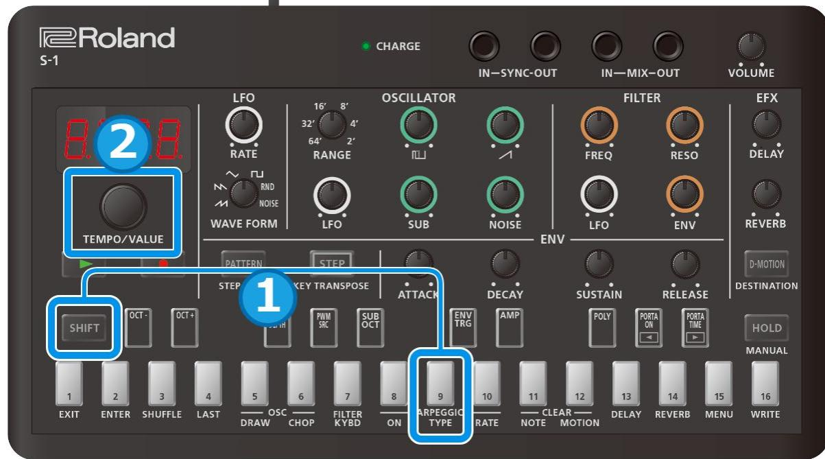
1. Halten Sie den [SHIFT]-Taster gedrückt und drücken Sie das Pad [9] (ARPEGGIO TYPE).
