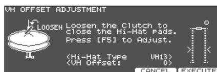
6. VH-13 のクラッチ・スクリューをゆるめ、ハイハットを閉じた状態にします。
