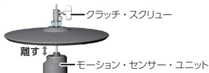
2. VH-10 のクラッチ・スクリューをゆるめ、ハイハットをモーション・センサー・ユニットの上に自然に置いた状態にします。
