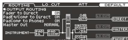
3. Wählen Sie mit den [F1] (ROUTING)–[F3] (ATT)-Tastern den gewünschten Parameter aus.
