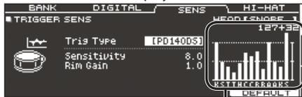
Velocity-Anzeige (zeigt die Stärke des Anschlags des Pads an)
