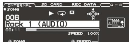
Sie können die Position mit den [◀] (◀◀) / [▶] (▶▶)-Tastern in 5-Sekunden-Schritten rückwärts oder vorwärts versetzen. Um die Position zu versetzen, halten Sie einen dieser Taster gedrückt.
