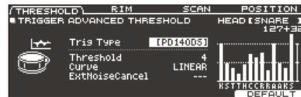
3. Wählen Sie mit den [F1] (THRESHOLD)–[F4] (POSITION)-Tastern den gewünschten Parameter aus.
