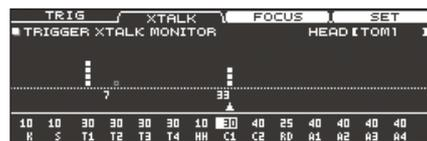
Wenn der Übersprech-Effekt für mehrere Pads auftritt, werden durch mehrfaches Drücken des [F3] (FOCUS)-Tasters die Pads nacheinander ausgewählt, bei denen der Übersprech-Effekt auftritt.
