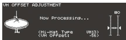
Der „VH Offset“-Parameter wird automatisch eingestellt (dieses dauert ca. 3 Sekunden).
