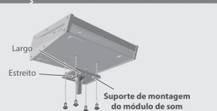
Insira o suporte de montagem no prendedor e depois gire a borboleta do prendedor para prender o suporte de montagem. Prenda os cabos no suporte com a abraçadeira de cabo.
