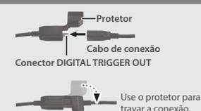
Use o protetor para travar a conexão.
