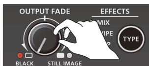
プログラム出力映像から黒画面にフェード・アウトします。フェードがかかると、[OUTPUT FADE] つまみのインジケータが赤点減します。完全にフェード・アウトすると、赤点灯になります。
