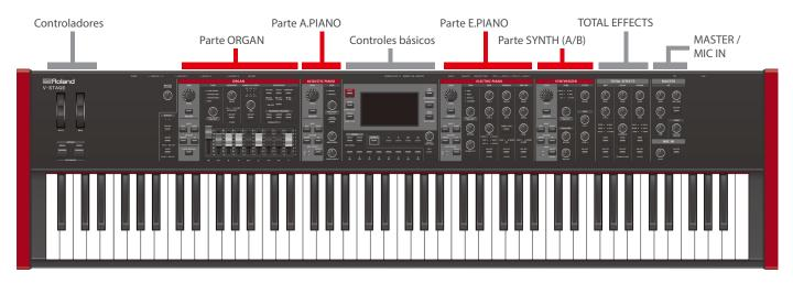
O V-STAGE tem cinco partes de gerador de som independentes, além de TOTAL EFFECTS, MASTER e uma seção de controladores. Cada parte do gerador de som tem um efeito dedicado (\*). Ative as partes que você quer tocar no teclado. Você pode juntar várias partes ou dividir o teclado nas regiões esquerda e direita que usam sons diferentes.
