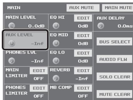
3. [VALUE] つまみで、AUXバス出力音声の音量を調整する。
