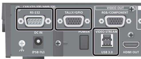
※ TALLY/GPIO 端子は、制御信号とタリー信号の出力にも対応しています。
