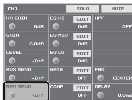
入力音声ごとにリバーブへの音声の送り量を設定できるので、リバーブのかかり具合を個別に調整することができます。
