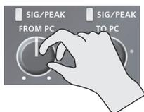
USB 入力音声を使わないときは、[FROM PC] つまみを反時計方向いっぱい回して、音量を絞ります。
