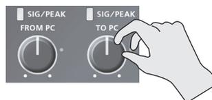
適正に音量が調整できているかどうか、SIG/PEAK インジケータ―やレベル・メーターの点灯色で確認できます。黄点灯する程度が適正です。
