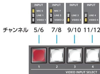
たとえば、チャンネル 5/6 の音声は、VIDEO INPUT SELECT [1] ボタンが選ばれたときのみ出力されます。
