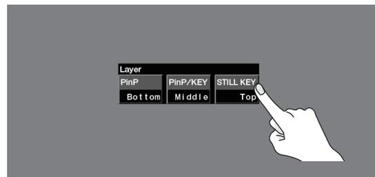
4. 「Top」に設定されたレイヤーのボタンにタッチして、Top以外のレイヤーの重なり順を設定します。
