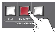
[PinP/KEY] ボタンが赤点灯し、合成結果がプログラム出力されます。
