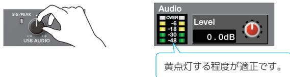
音声バスの割り当てに応じて、以下の音量が調節されます。
