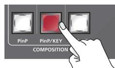
[PinP/KEY] ボタンが赤点灯し、合成結果がプログラム出力されます。
