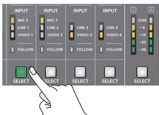
2. Input <MIC>、<LINE>、または<VIDEO>にタッチして、音声ソースを選びます。
