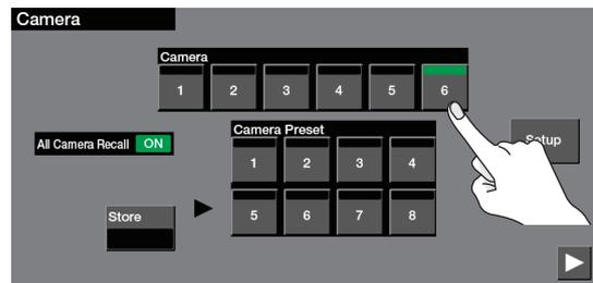
2. <▶> ⇒ メニュー項目にタッチして、カメラの設定を操作します。
