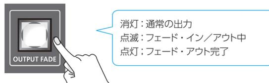
プログラム出力映像から黒画面にフェード・アウトします。完全にフェード・アウトすると、[OUTPUT FADE] ボタンが点灯します。
