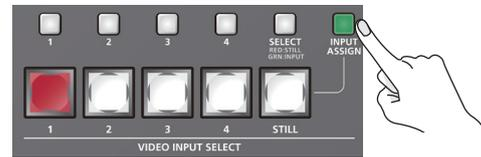
[INPUT ASSIGN] ボタンが点灯し、映像ソースの選択画面が表示されます。
