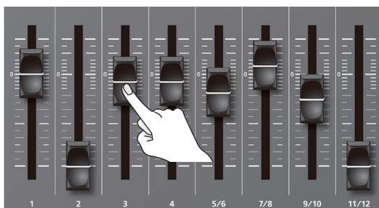
3. [MAIN] フェーダーで、出力音量を調節します。
