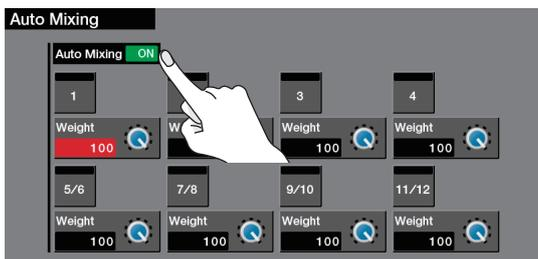
4. チャンネル・スイッチにタッチして、オート・ミキシングの対象とするチャンネルをオン (点灯) にします。
