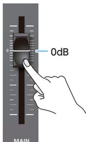
2. スピーカーやヘッドホンで音声を聴きながら、オーディオ・フェーダーで各入力の音量バランスを調整します。
