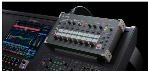
Mezcladora Personal M-48 siendo usada como Monitor de Ingeniero, alimentada eléctricamente vía el puerto Backup.
